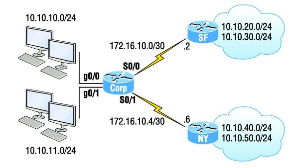
Corp#config t Corp(config)#router eigrp 20 Corp(config-router)#network 172.16.0.0 Corp(config-router)#network 10.0.0.0
